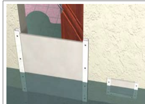
Batardeau de porte et couvercle d'entrée d'air limitant la pénétration de l'eau
